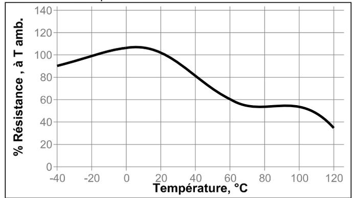
**Résistance au vieillissement à chaud : Vieillessement à la température indiquée et mesure après retour à 22 °C**
