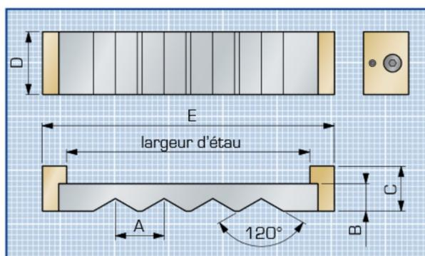
Pour le serrage vertical de pièces cylindriques. Mors fixes avec flancs de fixation et pontets [A] reliant les pistons entre eux.
